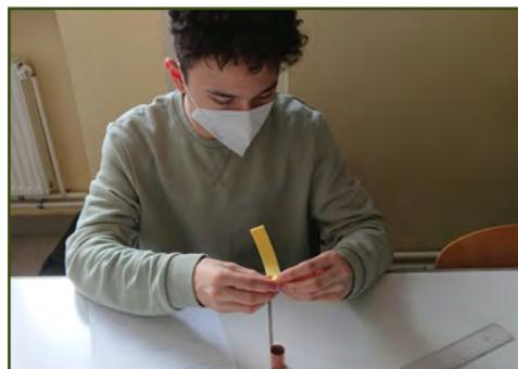
Ein Streifen aus Schwammtuch als Elektrolyt-träger wird um ein Stück Magnesiumspitzer gewickelt.
